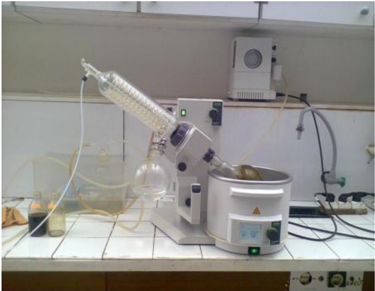
Figure 21 : Photographie représentant un appareil Rotavapor.
