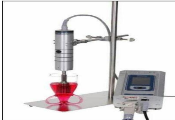
Figure 14 : Extraction par ultrasons.
